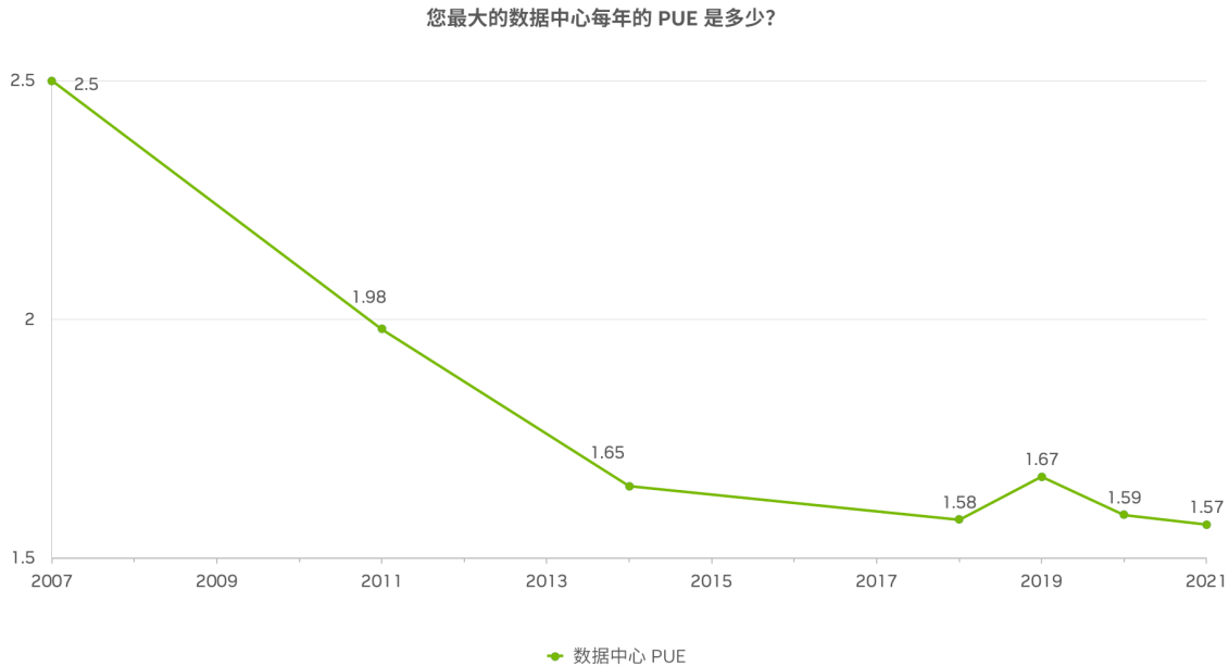
图 2： 数据中心 PUE 自 2007 年以来出现了大幅下降，但近年来已趋于平稳。 (资料来源： Uptime Institute 2021 年调查 。)
